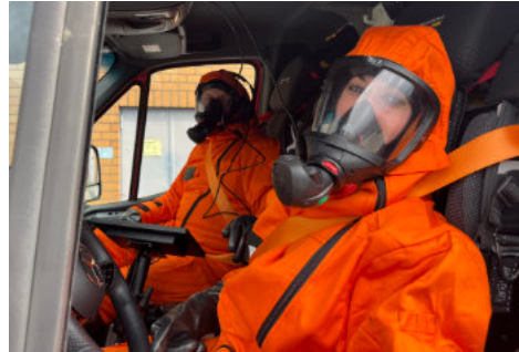
In den Sitzen integrierte Pressluftatmer und Intercom-System
