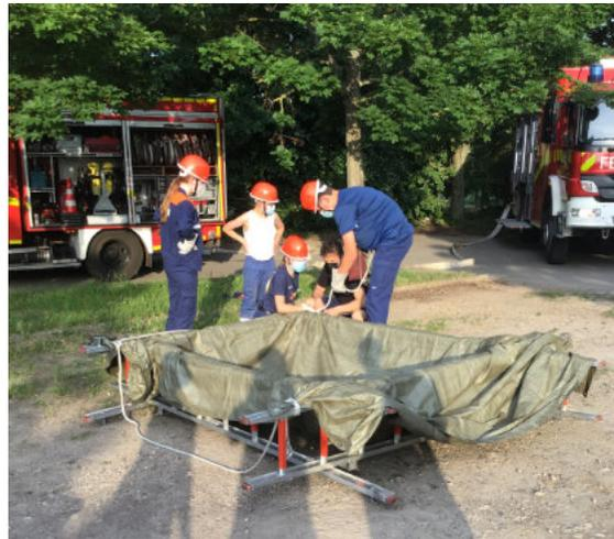
Aufbau eines behelfsmäßigen Auffangbeckens für Löschwasser
