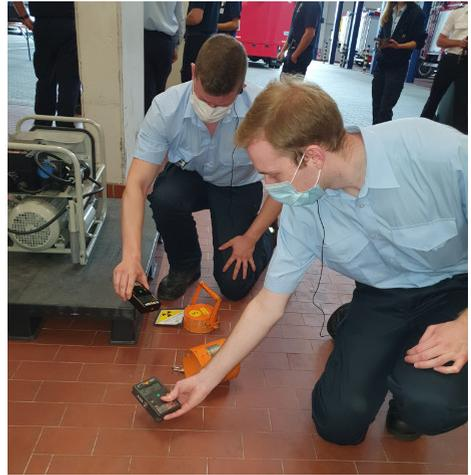
Nicolas und Tim bei einer Messübung (Radioaktivität) mit dem Dosisleistungsmessgerät
